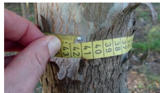
Kontroll-Messung eines Eukalyptus-Baumstamms: der Umfang wird in Brusthöhe erfasst.
