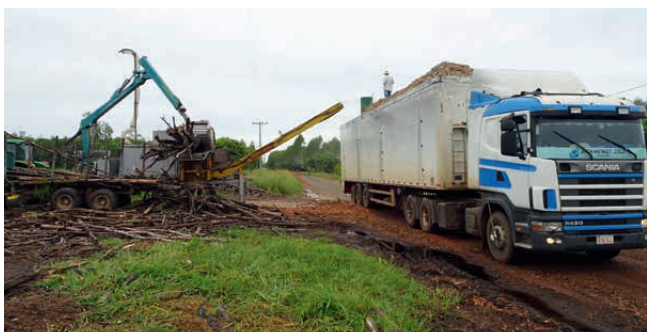
Holzackschnitzel: Hier werden mit einem Häcksler Hack-schnitzel direkt vor Ort produziert.
